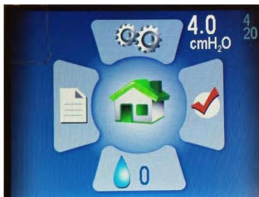
主屏幕右上角的白色数字显示设定压力（大数字）和最小和最大压力（较小，颜色较淡的数字 - 此图像中为4和20）。
