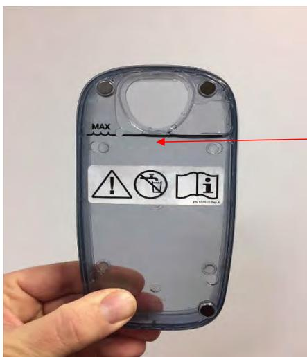
水位应填充至储水罐密封处底部并与储液罐水位线齐平。
